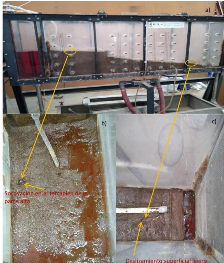
Figura 7. a) perfil de medio poroso sobresaturado. b) vista en planta de la aparición de una socavación. c) vista en planta de la presencia de un deslizamiento superficial ligero.
